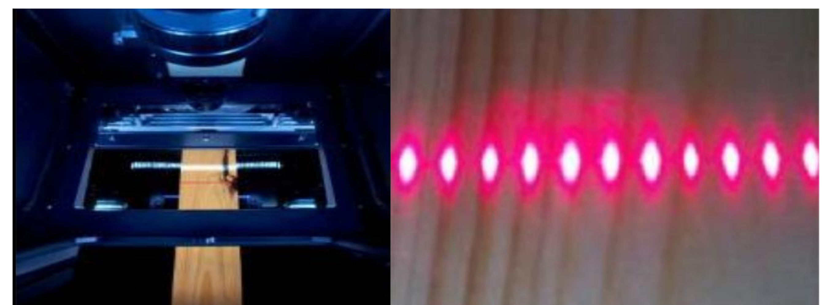
Mesure de la pente de fil à l'aide d'un faisceau de lasers
