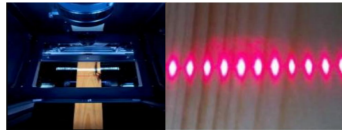
Mesure de la pente de fil à l'aide d'un faisceau de lasers
