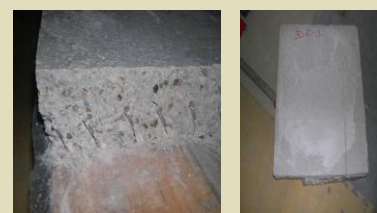
FIG. 7 – Modes de rupture du matériau
