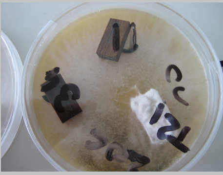
FIGURE 5 : Test de résistance aux attaques fongiques
